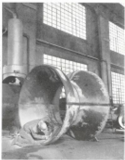
Scalpellatore, per ripresa della costruzione, di due forni per caldaie destinate all'impianto di Sestri (continua) per la produzione di fertilizzanti azotati. C'è al lavoro l'operato Marino Borelli.
